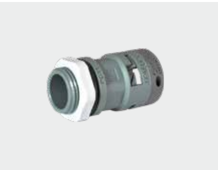
KTR-R 707132* RACCORDO DIRITTO PG11 per guaina Ø 12mm (Mod. KTR-G) completo di dado e guarnizione. Adatto per kit passaggio cavi Mod. "KT5", colore grigio.
