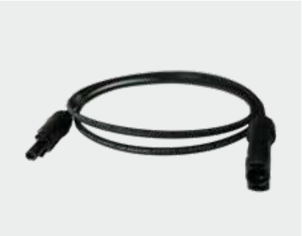
KTP-I5 707074 Prolunga cavo solare 1x4mm 2 , length 1,5 metres, completa di connettori MC4 M/F.
