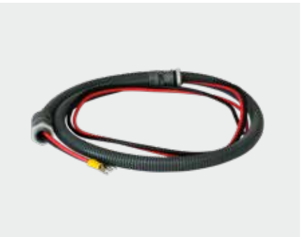
KT5-C10 707051 KIT CABLAGGIO PER PASSACAVO "KT5" composto da guaina L=1m e due cavi da 6mm 2 L=2m. Completo di raccordi PG11 e capicorda per il collegamento al modulo fotovoltaico.
