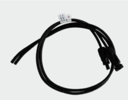
KT51-C50 707073 KIT CABLAGGIO per moduli fotovoltaici CBE ultima serie, completo di cavo resistente ai raggi UV, 2 x 4 mm 2 , lunghezza 5 metri e connettori attacco rapido di tipo "solare".
