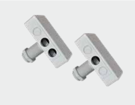
KT51 707070 KIT 5 VIE con 2 fori per PG11 per il passaggio cavi di moduli fotovoltaici, telecamere, antenne, ecc., dal tetto. Adatto per tetti di spessore massimo 60mm.
