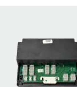
DLS350 Nodo luci Dimmer "DLS350" bus 7 CANALI CODICE: 204452
