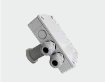
KT51-PG 707071 KIT 5 VIE completo di 2 pressacavi PG11 per il passaggio cavi di moduli fotovoltaici, telecamere, antenne, ecc., dal tetto. Adatto per tetti di spessore massimo 60mm.
