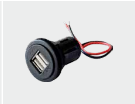
R550/UU 212930** 002767DP* Preso doppia USB 5V 2 x 2,5 A (Tensione alimentazione ingresso 12 V)
